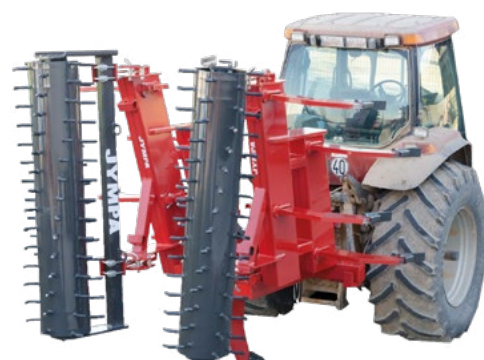
Modèle RIGEL-9-2V-PC avec rouleau simple Ø 580 mm
