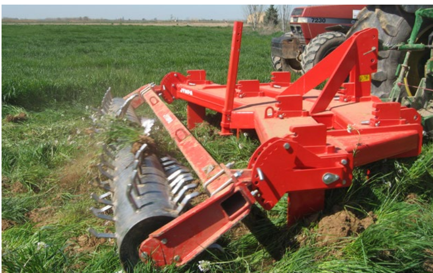
Modèle RIGEL-7-2V-440 avec rouleau simple Ø 580 mm et socs en acier moulé
