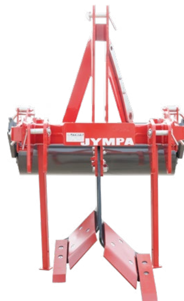
Modèle MINTAKA-1 avec rouleau lisse Ø 325 mm
