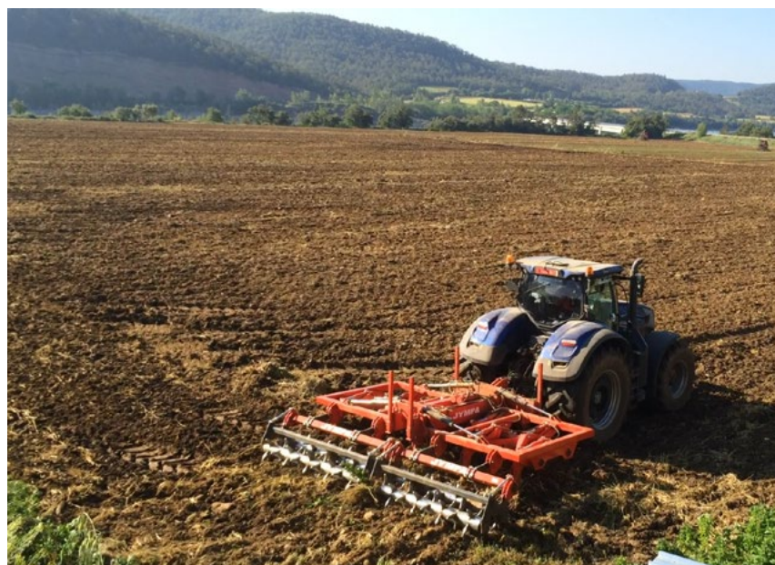
Modelo POLARIS-7 con rodillo doble Ø 520 mm con regulación mecánica
