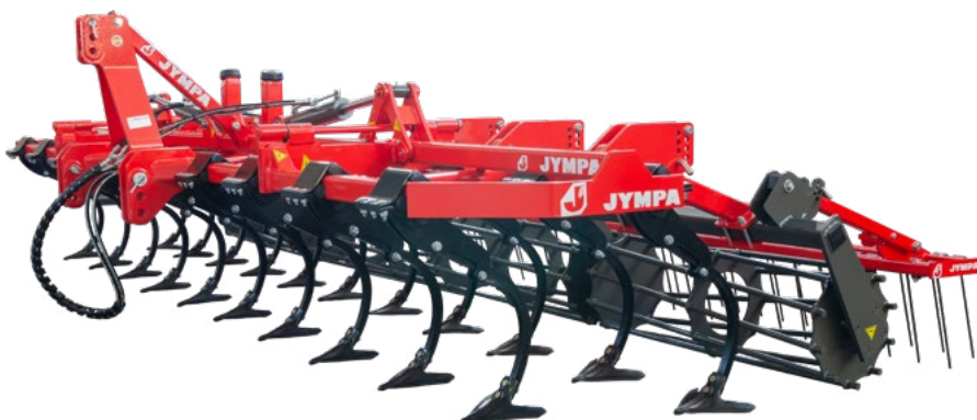
Modèle OSIRIS-EL-19-2F-PL avec socs à patte-d'oie, amortissement en élastomères, rouleau à barres simple et herse.
