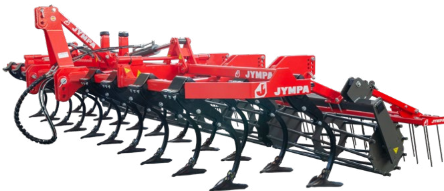
Modèle OSIRIS-EL-19-2F-PL avec socs hirondelles, amortissement en élastomères, rouleau barres simple et herse.
